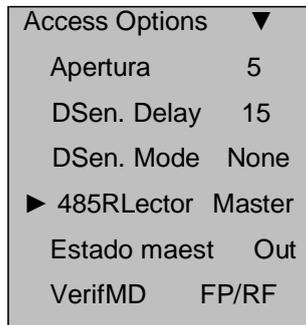
El equipo soporta la función de lector 485 y mediante esta puede ser conectado a un lector FR1200.
