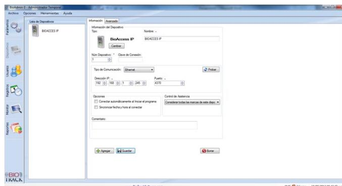
**7** Finalmente se configura la computadora con la dirección IP respectiva de la red del cliente. Si usa una dirección IP automática omite este paso.
