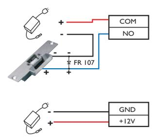
Importante: La longitud del cable entre el dispositivo y la fuente de poder debe ser menor a 3 metros.
